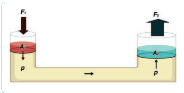
Gambar 3.10 Model dongkrak hidrolik.
