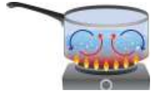
Gambar 3.10 Konveksi saat memasak air.
