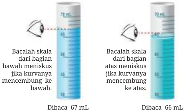
Gambar 1.18 Pengukuran volume cairan.
