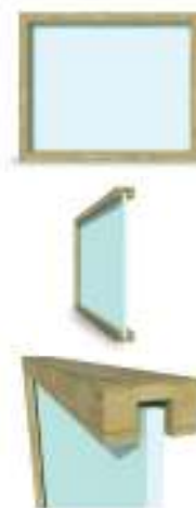
Gambar 3.16 Dudukan jendela dibuat lebar, untukantisipasi pemuaian luas.
